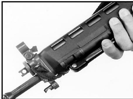
Figure 29: Fixation du brin de cordelette avant, variante pour gaucher
